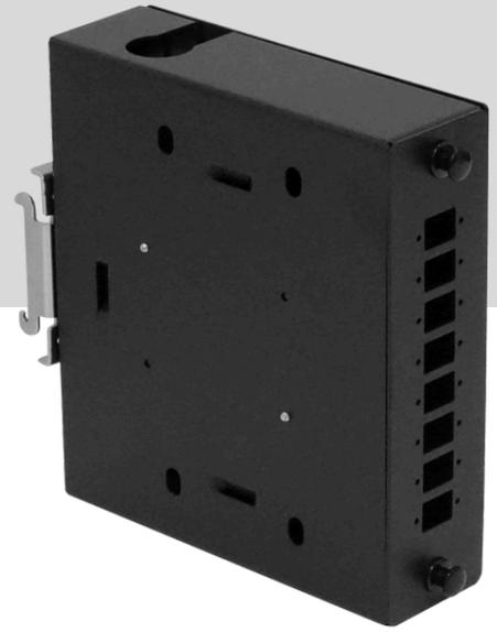
Caja de terminación para fibra óptica tipo paso. Permite entrada y salida de fibra multiple pequeña. Para uso interior IP20. Requiere placa para adaptadores minicopla. Para ordenar tiene bandeja con pivote. Se cierra con presión. Incluye 4 manguitos y tarugos para montaje mural. También permite montaje en riel Din (para tablero eléctrico).
